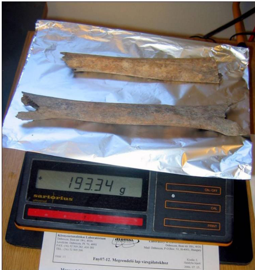
6. kép: Jó megtartású csont esetében ez a mintamennyiség általában elég a ^{14}\text{C} aktivitásméréshez (feltéve, hogy a tömeg nagyobb részét nem a csonton lévő lerakódás, illetve a csont üregében lévő föld teszi ki). AMS esetében egy szilánk is elegendő.
