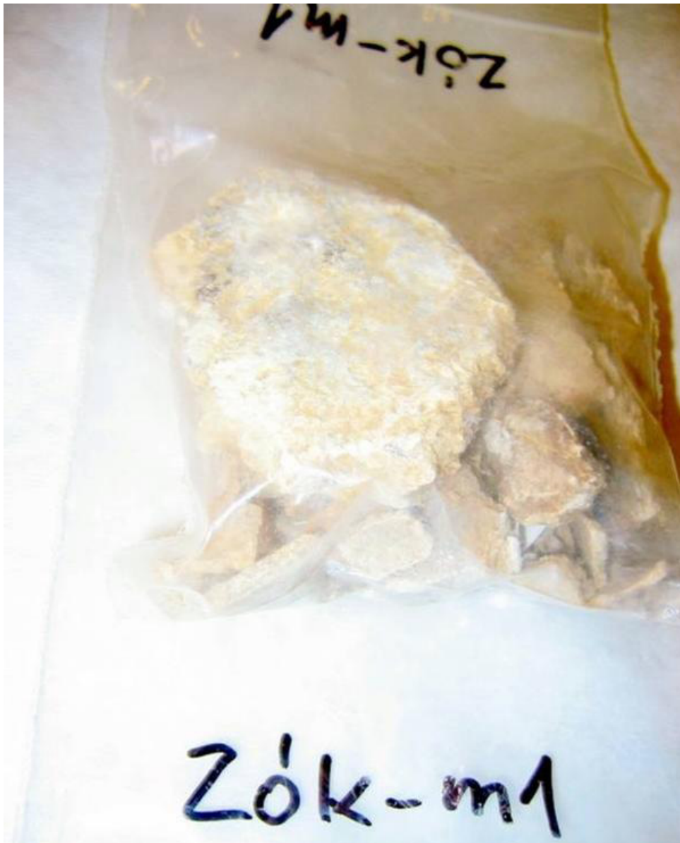
12. kép: Minta simítózáras polietilén tasakban. A mintakódot (azonosítót) a tasakra írták alkoholos filccel. A minta további adatai – a kóddal együtt – a megrendelőlapra szerepelnek.
