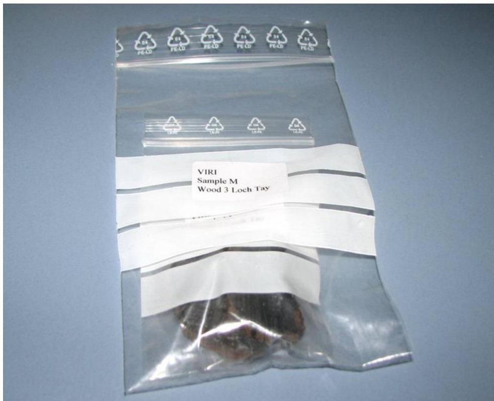
13. kép: A nemzetközi összemérésre érkezett minták csomagolása dupla simítózáras polietilén tasak. A belső tasak tartalmazza a mintát, amelyben a minta semmivel nem érintkezik, semmilyen jelzés vagy jelölés nincs rajta. A külső tasak a fokozott biztonságot szolgálja. Mindkét tasak külső részére felragasztották a minta azonosító kódját.
