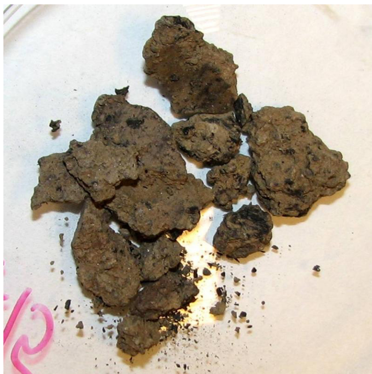
11. kép: Föld, benne apró faszéndarabkák. Csak a minta előkészítése során derül ki, hogy mennyi benne a mérésre alkalmas anyag. Különösen nagy átverést okozhat, ha szép fekete földbe vannak a faszéndarabkák beágyazva.
