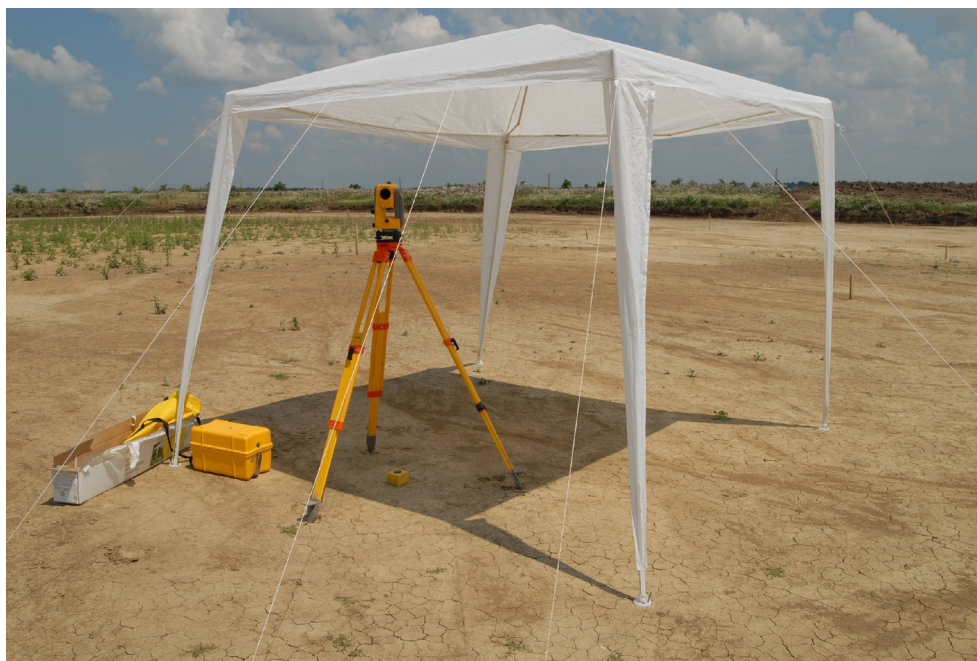
6–7. kép: Ásatási négyzetháló kitűzése és a metszet koordináta-rendszere
