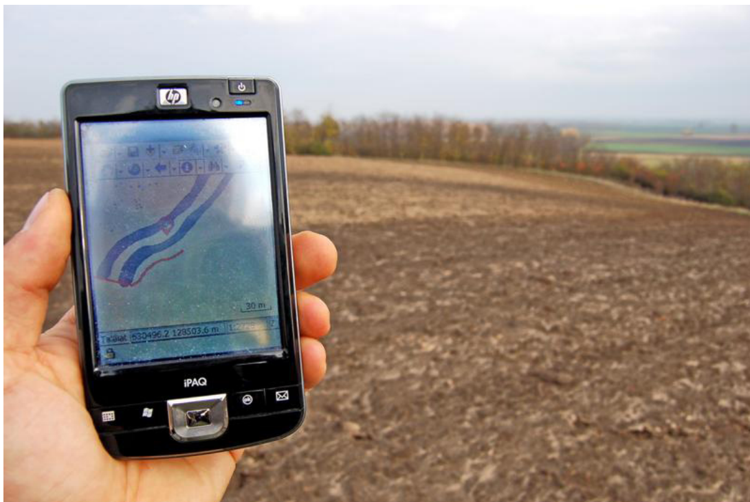
19. kép: A PDA-n működő térinformatikai rendszer terepi használata. A helyszínen azonosítható nyomok összehasonlíthatók a légi fotó térképpel, valamint pontosságuk is ellenőrizhető.
